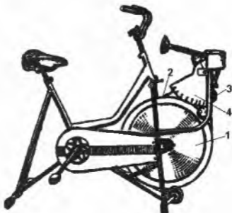
Рис. 1.2. Велоэргометр. Обозначения: 1 — колесо-маховик, 2 — лента-привод, 3 — вращающийся барабан, 4 — маятник-стрелка со шкалой для установки отягощения нагрузки (от нуля до 7 кг).
