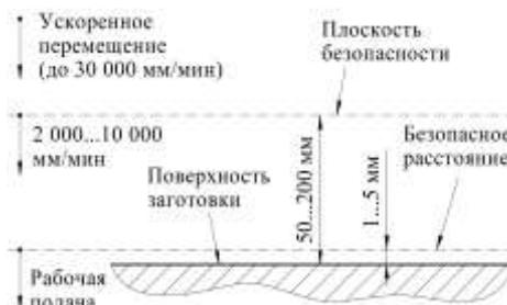
Рис. 1.1. Изменение скорости подачи при подходе к заготовке
