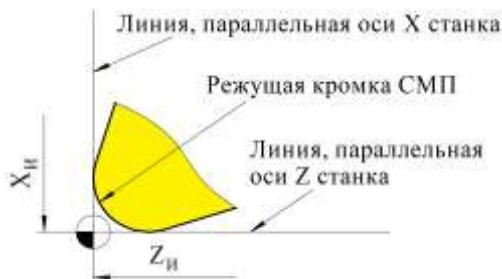
Рис. 6.7. Связь НИ и режущей кромки СМП
