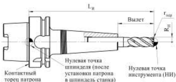
Рис. 6.12. НИ при установке в термоусадочный патрон
