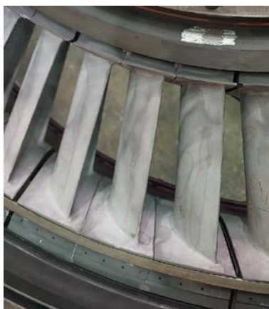
Рис. 4 – Зазоры по стыкам сопловых секций в составе аппарата
