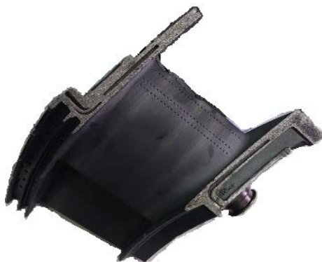
Рис. 2 – Вид паяного соединения после термоциклических испытаний и разрезки блока сопловых лопаток
