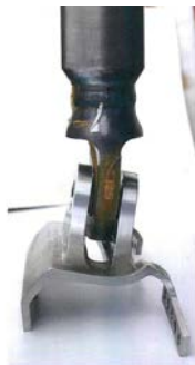
Рис. 4 – Деформации тяги и кронштейна опоры турбины
