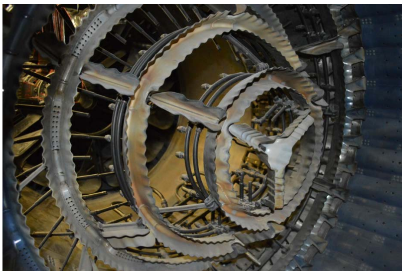
Рис. 1 – Расположение V-образных стабилизаторов горения (плохообтекаемых тел) форсажной камеры ТРД
