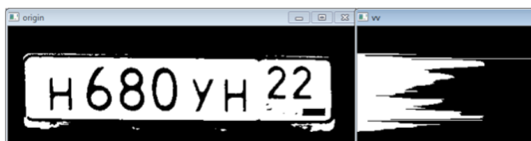
Рисунок 4. Бинаризация автомобильного номера и гистограмма.
