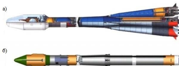
Рис.1. РН типа «Союз 2»: а) трёхступенчатая, б) двухступенчатая
