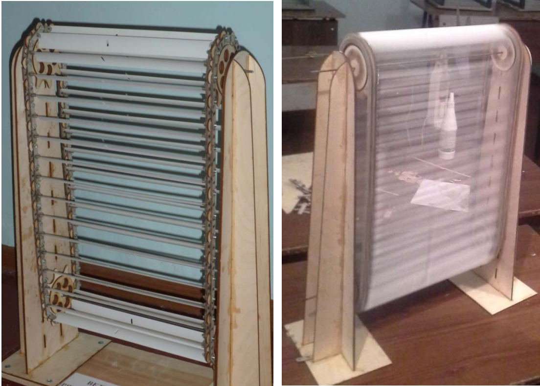
Рис. 1. Модель ветродвигателя – нории. Конструкция и работа
