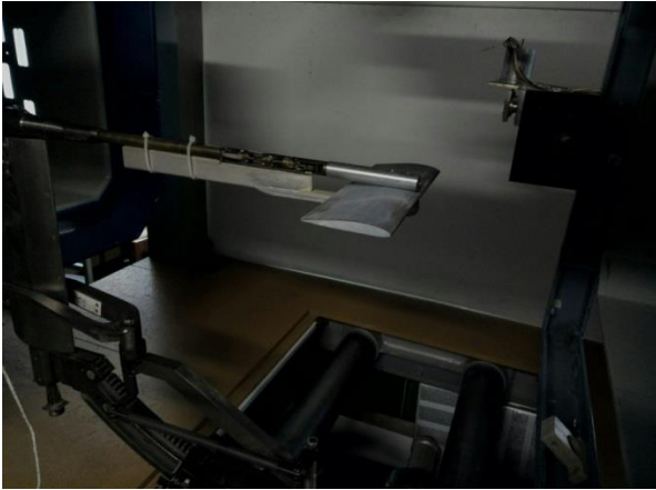
Рис. 2. Эксперимент с державкой вблизи малого крыла
