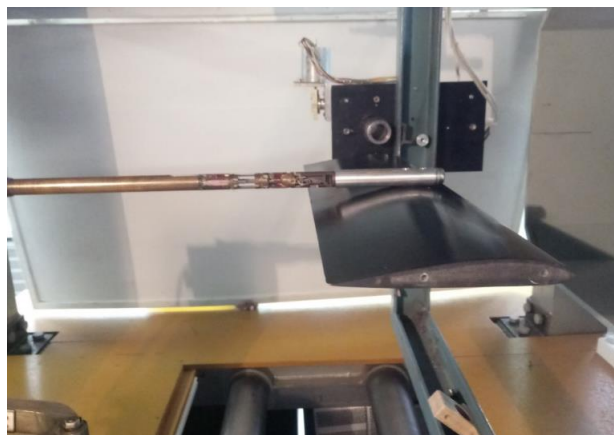
Рис. 5. Эксперимент с крылом большого размаха
