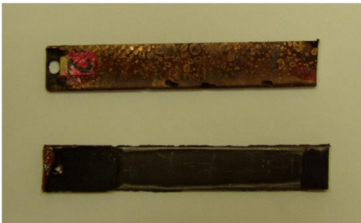
Рис. 1. Плоские образцы из стали 30ХГСА
