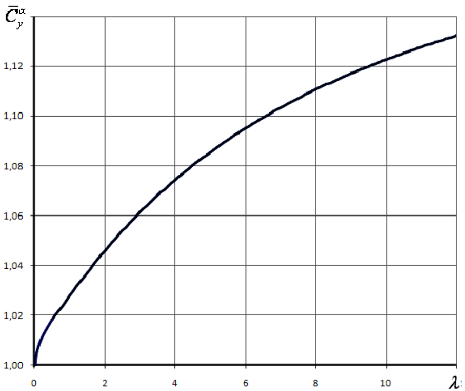
Рис. 4. Зависимость максимальных значений отношения производных коэффициентов нормальной силы по углу атаки комбинации фюзеляж-крыло и исходного крыла от удлинения крыла
