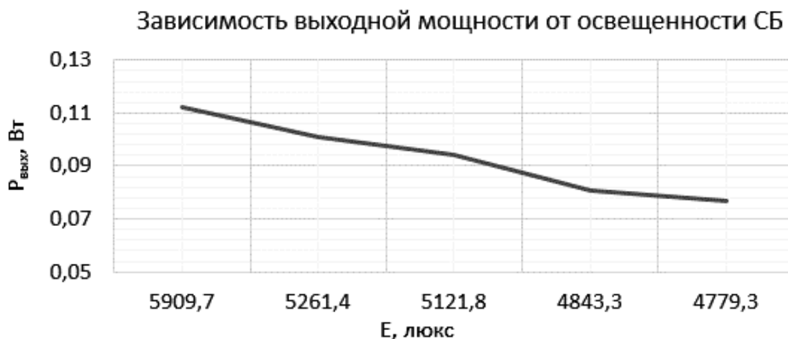
Рис. 3. График зависимости выходной мощности СБ от ее освещённости
