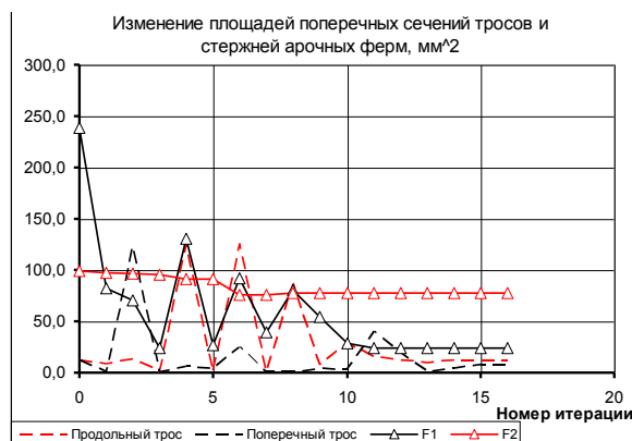
Рис. 6. Изменение площадей поперечных сечений тросов и стержней арочных ферм в ходе итерационного процесса
