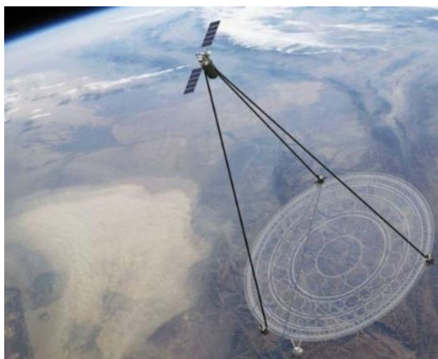
Рис. 1. Проект геостационарного КАН с мембранной оптической системой (MOIRE – Membrane Optical Imager for Real-Time Exploitation)
