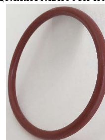
Рис. 4. Внешний вид уплотнительного кольца после воздействия масла ВНИИНП-50-1-4Ф
