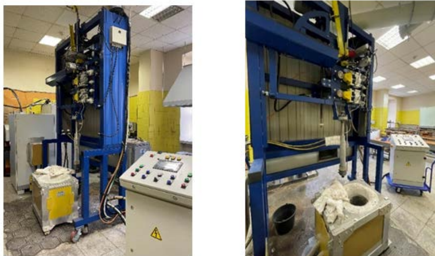
Рис. 4. Комплекс ПУВЛ-450.ПС с индукционной тигельной печью
