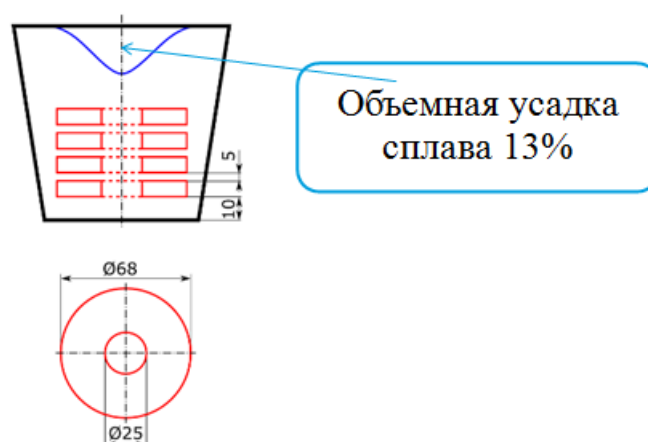
Рис. 3. Схема вырезки образцов
