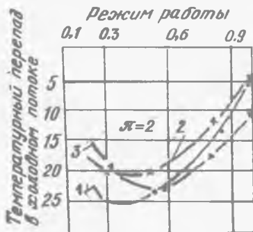
Р и с. 3. Зависимость температурного перепада от режима работы аппарата: Материал ВЗУ: 1 - фторопласт; 2 - эбонит; 3 - бронза
