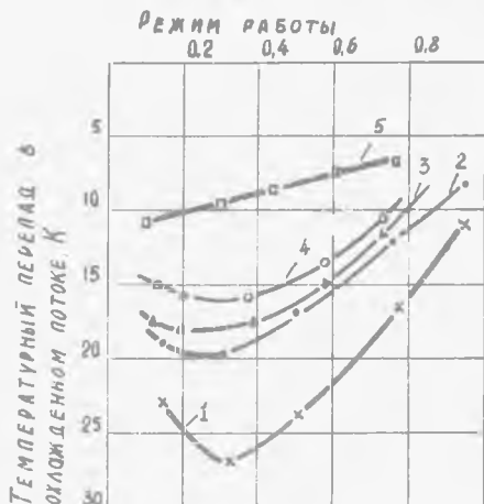
Р и с. 4. Влияние высоты винтовых простенков на энергетическое разделение: l_s = 29 мм; P = 0,4 МПа; \bar{F}_c = 3 , \beta_c = 0,07 ; 1 - h = 0 ; 2 - h = 1,2 мм; 3 - h = 3 мм; 4 - h = 4 мм; 5 - h = 6 мм
