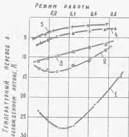
Р и с. 3. Влияние длины l_s простенка на энергетическое разделение: \bar{F}_c = 3 , h = 6 : 1 - l_s = 0 ; 2 - l_s = 14 мм; 3 - l_s = 29 мм; 4 - l_s = 49 мм; 5 - l_s = 186 мм
