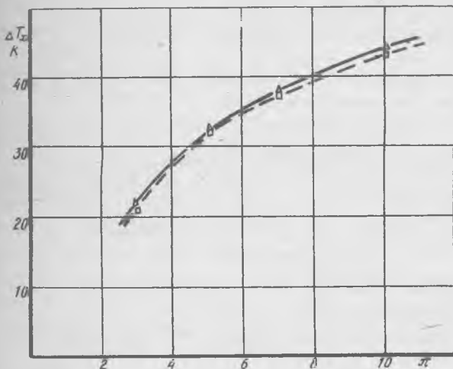
Р и с. 2. Зависимость эффекта охлаждения газа в вихревой трубе от отношения давлений, \Delta T_x , К от \pi :
