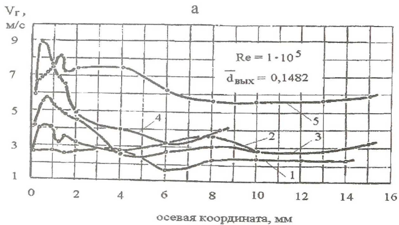
Рисунок 2- Распределение радиальной скорости в вихревой камере с гиперболическими торцевыми стенками. 1 - r = 0,867 ; 2 - r = 0,704 ; 3 - r = 0,556 ; 4 - r = 0,482 ; 5 - r = 0,407
