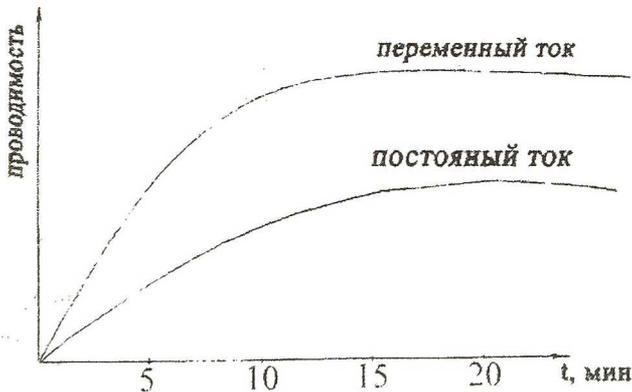
Рисунок 4 - Диаграмма вулканизации образца резины
