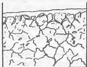
Р и с. 2. Микроструктура материала дефлектора с окисленным слоем после серийной термообработки
