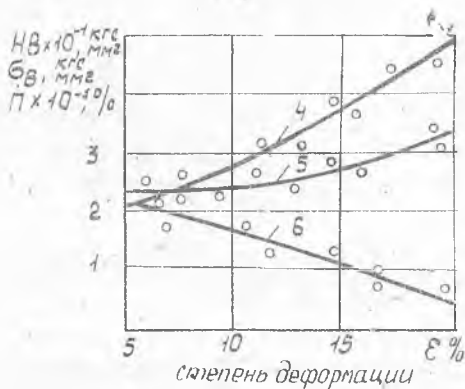
Р и с. 2. Зависимость свойств уплотнительной ленты а) от содержания нитрида бора, б) от степени деформации: 1 - температура 200°C; 2 - 700°C; 3 - 900°C; 4 - прочность \sigma_3 = 2,186 - 0,188\epsilon + 0,022\epsilon^2 - 0,0004\epsilon^3 кгс/мм 2 ; 5 - твердость HB = 0,006(\epsilon - 3,99)^{1,6} + 2,54 10 кгс/мм 2 ; 6 - плотность P = 2,0536(4,381\epsilon^{0,125} + 2,854) + 0,335 10%
