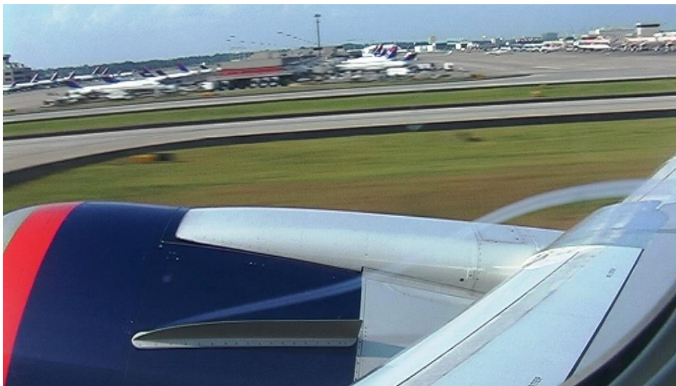
Рис. 2. Вихревой жгут от ВГ на мотогондоле двигателя
