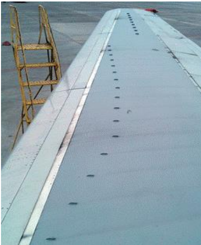
Рис. 3. ВГ на верхней поверхности крыла и на закрылке
