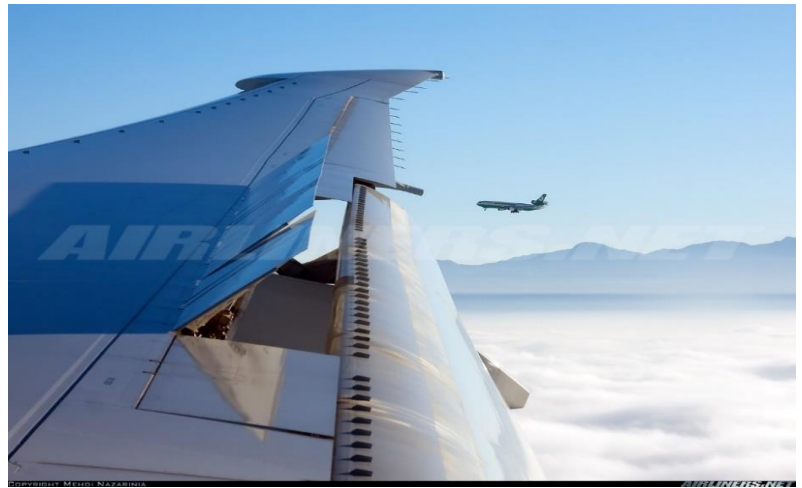
Рис. 3. ВГ на верхней поверхности крыла и на закрылке
