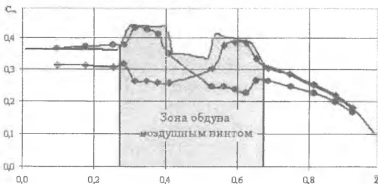
Рис. 4. Распределение коэффициента подъемной силы по размаху крыла с учетом влияния винта
