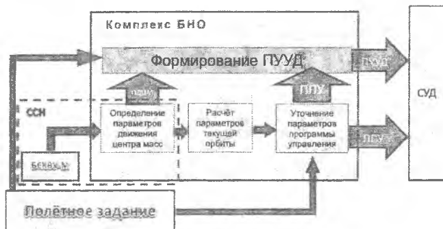
Рис. 2. Организация решения задачи управления движением разгонного блока
