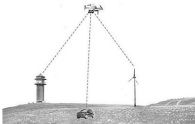
Рис. 2. Наведение первых двух камер на опорные объекты с известными координатами и третьей камеры на наземный объект (цель)
