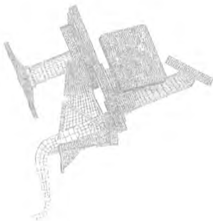
Рис. 6. Деформации модифицированной конструкции платформы ЧС для одного из случаев нагружения (в масштабе)
