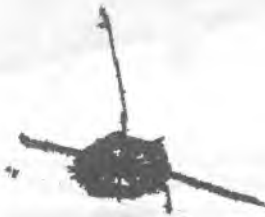
Рис. 13. Разрушенные элементы в стекле в момент времени 0,0003 с. Скорость столкновения 80 м/с. При данной скорости столкновения появляется характерная «паутинка» из окружных и радиальных трещин, затем происходит разлет крупных и мелких осколков
