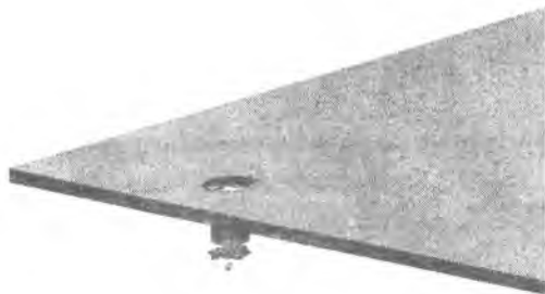
Рис. 15. Разрушенные элементы в стекле в момент времени 0,0001 с. Скорость столкновения 130 м/с. При данном разрушении существует плоскость откола параллельная внешней поверхности стекла и отстоящая на небольшом расстоянии от неё (десятые доли миллиметра), в результате чего от массива откалываются тонкие пластинки в форме чешуек
