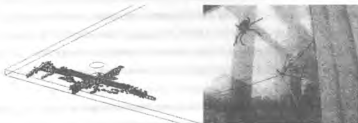
Рис. 9. Разрушенные элементы в стекле в момент времени 0,0003 с. Скорость столкновения 40 м/с. При данной скорости столкновения появляется характерная «паутинка» с преобладанием радиальных трещин
