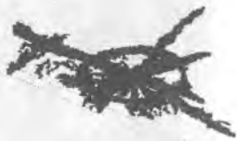
Рис. 11. Разрушенные элементы в стекле в момент времени 0,0003 с. Скорость столкновения 60 м/с. При данной скорости столкновения появляется характерная «паутинка» из окружных и радиальных трещин
