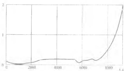
Рис. 3. Закон управления силой натяжения троса
