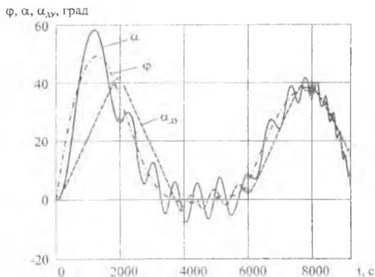
Рис. 4. Углы отклонения троса  $\varphi(t)$  и КА  $\alpha(t)$ ,  $\alpha_D(t)$  от вертикали
