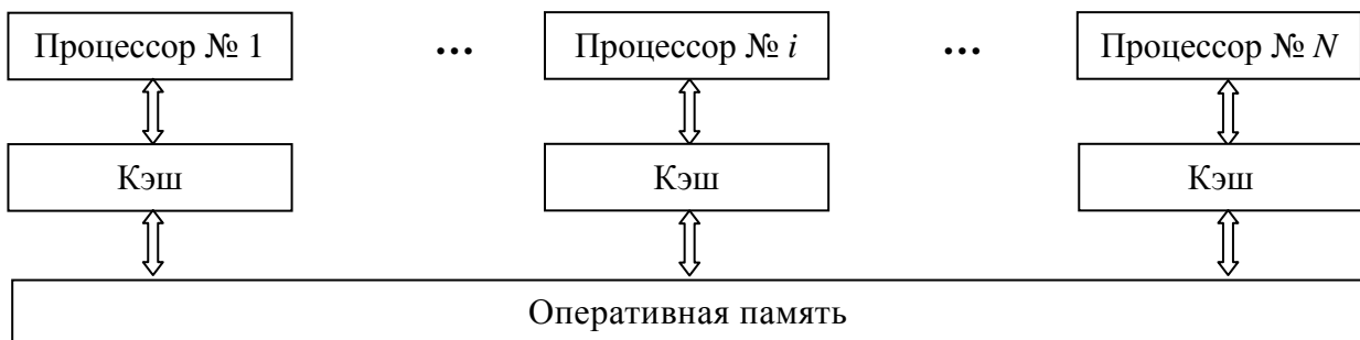
Рис. 3.1. Архитектура многопроцессорных систем с общей (разделяемой) памятью
