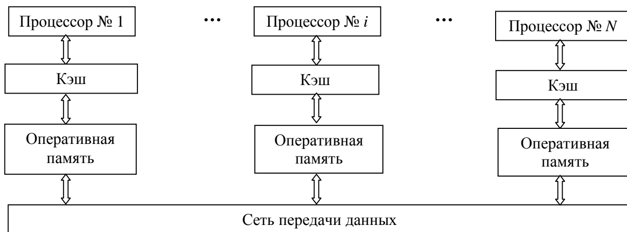
Рис. 3.2. Архитектура многопроцессорных систем с распределенной памятью
