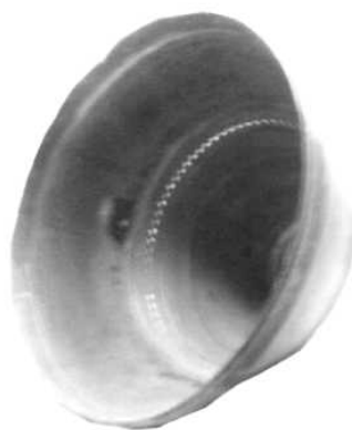
Рисунок 3 - Часть сопла, сплав ОТ4 (элемент камеры сгорания), габаритные размеры: диаметр 500 мм; толщина - 2...3 мм
