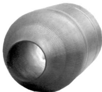
Рисунок 4 - Деталь «Рюмка», сплав 4В (элемент камеры сгорания), габаритные размеры: диаметр 500 мм; толщина - 2...3 мм
