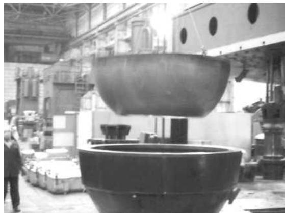
Рисунок 5 - Штамповка оболочки бытового отсека, алюминиевый сплав АД1, габаритные размеры: диаметр - 2500 мм; высота - 1500 мм; толщина - 2...3 мм
