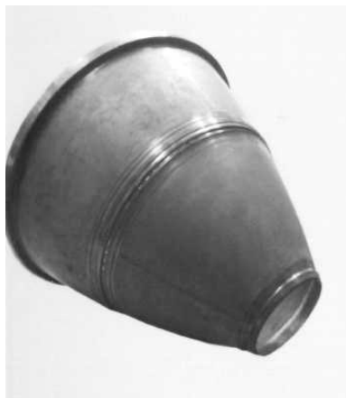
Рисунок 2 - Сопло, сплав ОТ4 (элемент камеры сгорания), габаритные размеры: диаметр 500 мм; толщина - 2...3 мм
