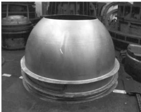
Рисунок 5 - Штамповка оболочки бытового отсека, алюминиевый сплав АД1, габаритные размеры: диаметр - 2500 мм; высота - 1500 мм; толщина - 2...3 мм
