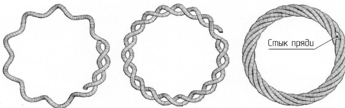
Рис. 3. Схема свивки колец для формирования упругих элементов
