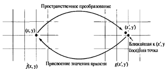
Рисунок 46 – Интерполяция значений яркости методом приближения по «ближайшему соседу»
