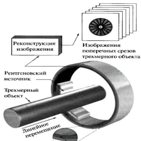
Рисунок 4 – Считывание изображений с помощью кольцеобразного набора сенсоров
