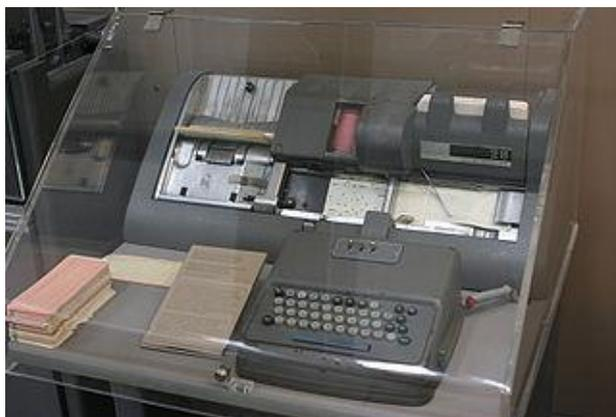
Рис. 1.2. Перфоратор IBM 026
