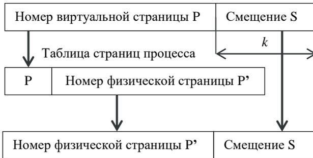
Рис. 10.6. Схема преобразования адреса при страничной организации памяти
