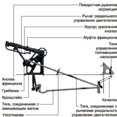
Рис. 2.15. Левая ручка ШАГ-ГАЗ
