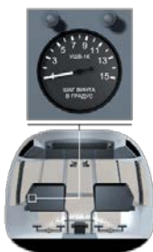
Рис. 2.14. Указатель шага винта
