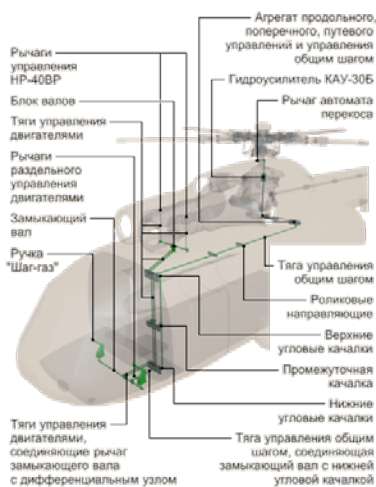
Рис. 2.13. Схема объединенного управления
