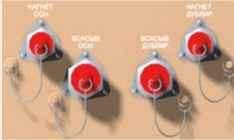
Рис. 1.14. Бортовая панель подключения наземной гидроустановки расположена снаружи центральной части фюзеляжа между шпангоутами №12 и 13 с левой стороны по полету.
