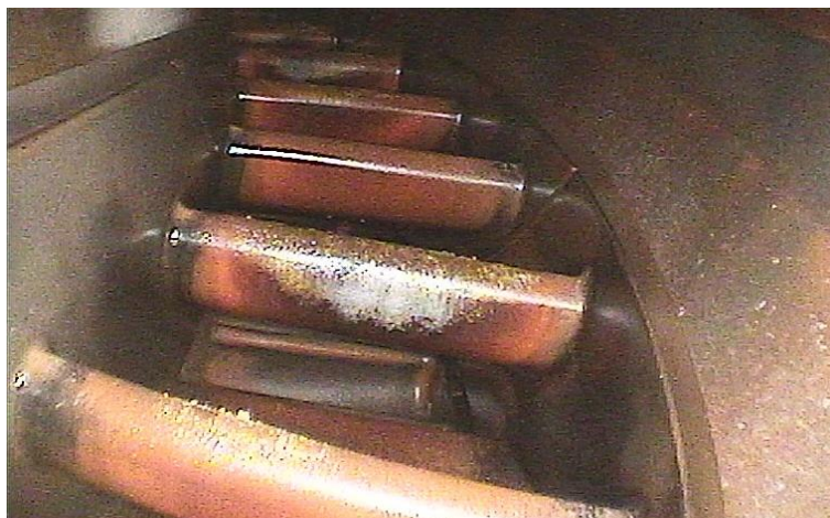
Рис. 24. Налет на РЛ 1 ступени турбины
