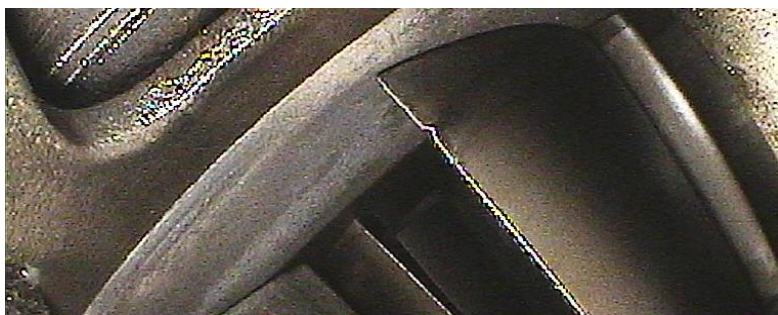
Рис. 20. Забоина на входной кромке рабочей лопатки 7 ступени компрессора до 1 мм
