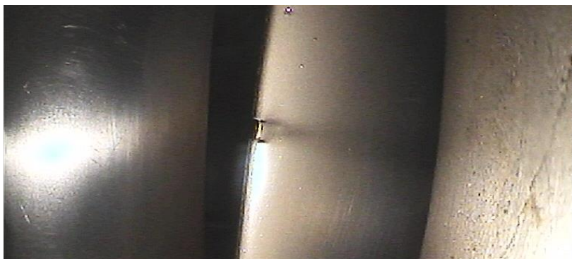
Рис. 23. Забоина на входной кромке рабочей лопатки 9 ступени компрессора до 1 \times 0,5 мм
