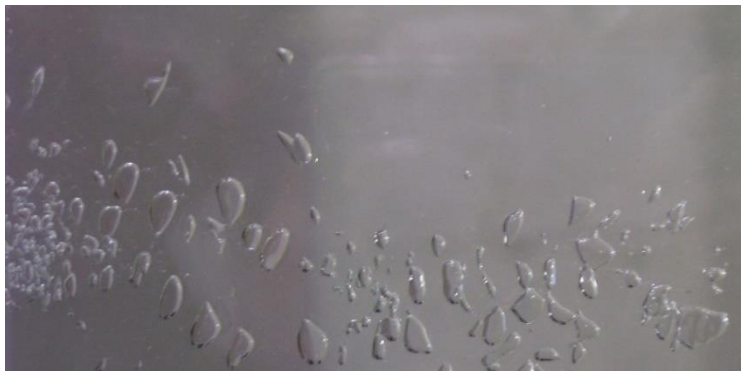
Рис. 4. Технологические пузыри на стекле (увеличенное изображение)
