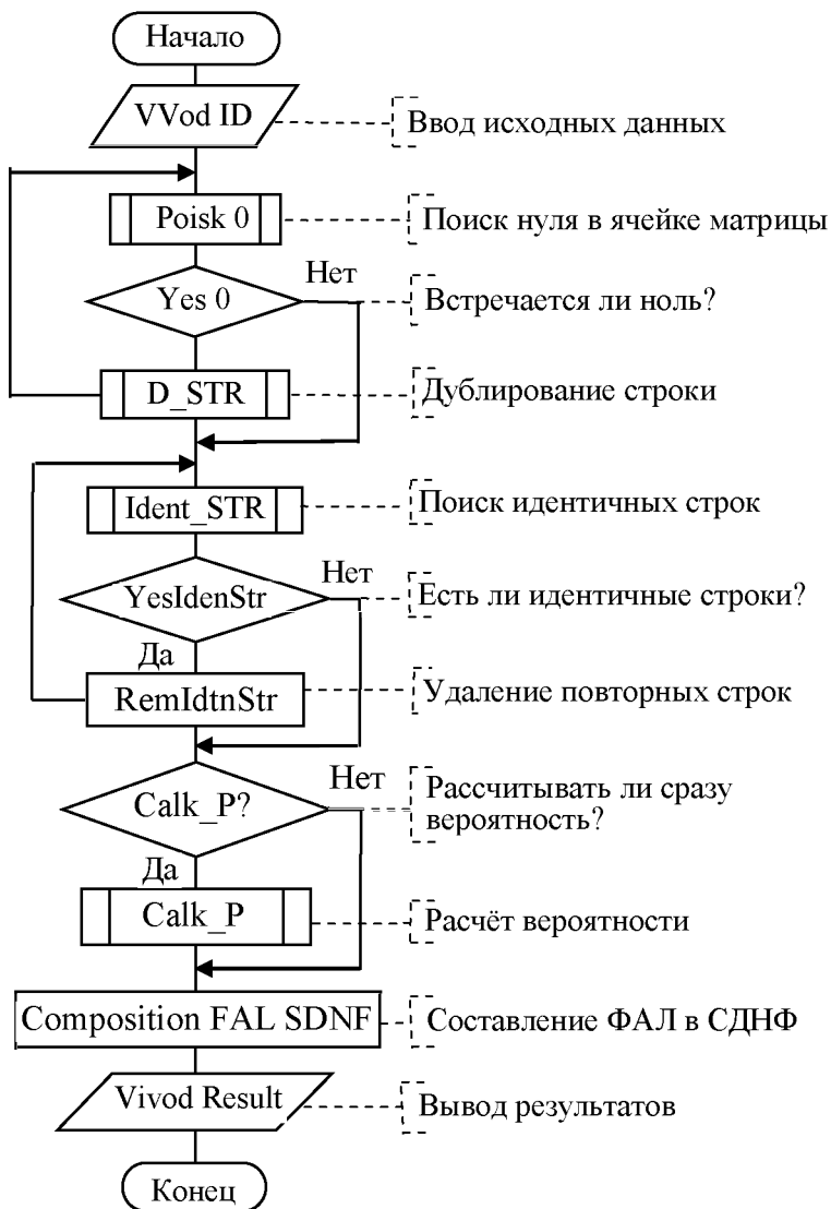
Рис. 8.3. Блок-схема алгоритма приведения логической функции к совершенной дизъюнктивной нормальной форме и расчёта вероятности
