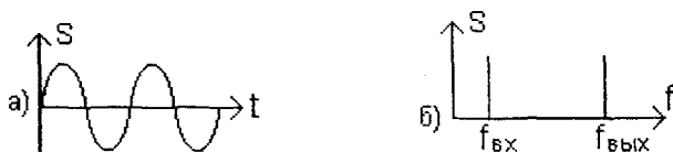
Рис.5.12 Выходной сигнал ЛБВ (а) и его спектр (б) при изменении фазы сигнала, кратном 2\pi
