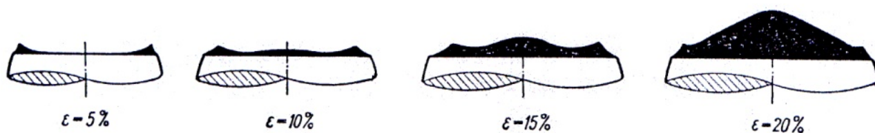
Рис. 4.6. Изменение высоты гребешка в зависимости от степени осадки
