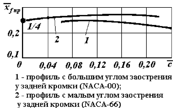
Рис. 24. Зависимость положения фокуса профиля по углу атаки от его толщины
