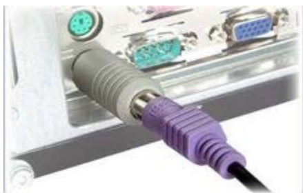
Рис. 5.3. «Закладка» на разьеме клавиатуры
