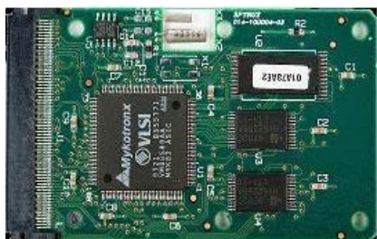
а) Шифровальная «карточка» в формате РСМСІ для подключения к ноутбуку (США)
