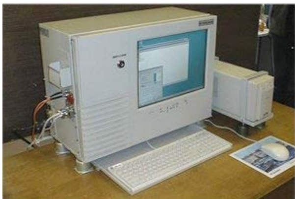
а) Защитно-экранирующий кожух для ЭВМ
