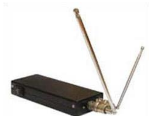
б) Генератор электромагнитного шума
