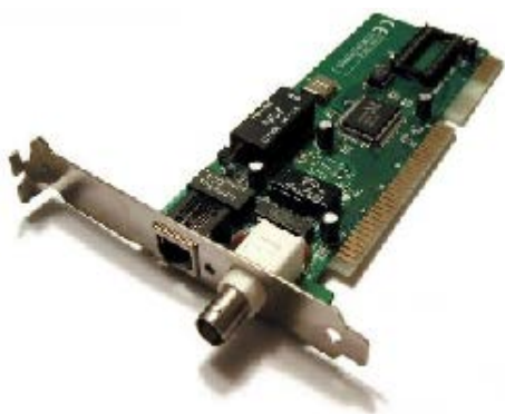
Рис. 6.9. Ethernet-плата с разъемами под витую пару и коаксиал
