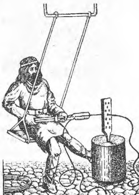
Рис. 2. Приспособление с качающимся сиденьем для волочения проволоки
