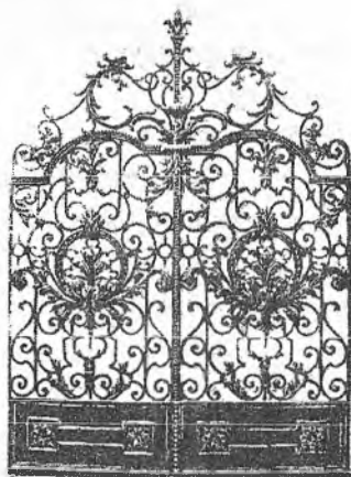
Рис. 11. Ворота, изготовленные свободной ковкой
