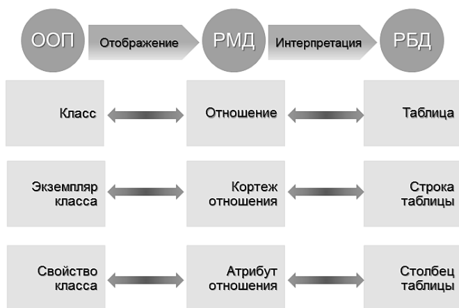
Рисунок 5 – Схема работы технологии ORM
