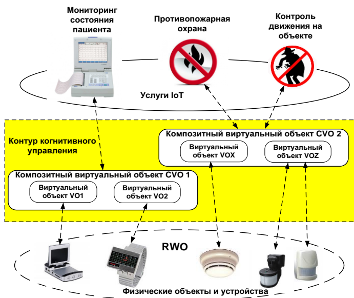
Рис. 1.4. Схема когнитивного управления
