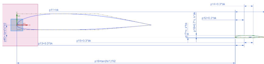
Рисунок 7.2 – Эскиз концевой профиля крыла относительно начала координат (на заднем плане – корневой профиль)
