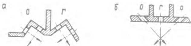
Р и с. 4.5. Схемы форсунок с пересекающимися струями: а - пересечение струи одного компонента; б - пересечение нескольких струи двух компонентов
