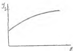
Р и с.1.7. Зависимость удельного импульса от степени расширения в сопле
