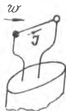
Рис. 2.27 Первичный преобразователь термоманометра
