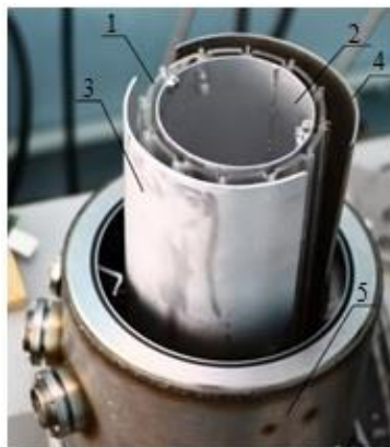
Рис. 30. Лабораторный макет СОТР в вакуумной камере: 1 – корпус, 2 – тепловой экран, 3 – имитатор температур космического пространства, 4 – имитатор внешних тепловых потоков, 5 – вакуумная камера (на снимке колпак вакуумной камеры снят, макет еще не укрыт ЭВТИ)
