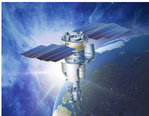
Рис. 13. Космический аппарат «Ресурс-ДК1» для панхроматической и многоспектральной съемки поверхности Земли с разрешением 1м
