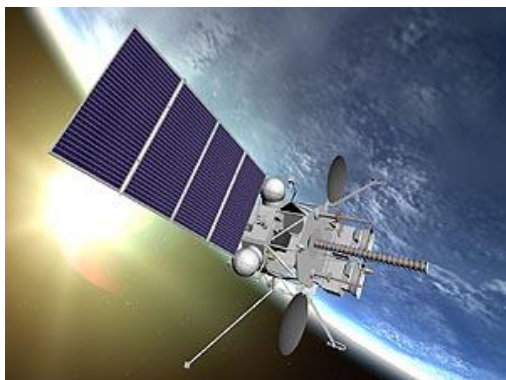
Рис. 12. Космический аппарат «Электро-Л» для сбора и ретрансляции метеоинформации
