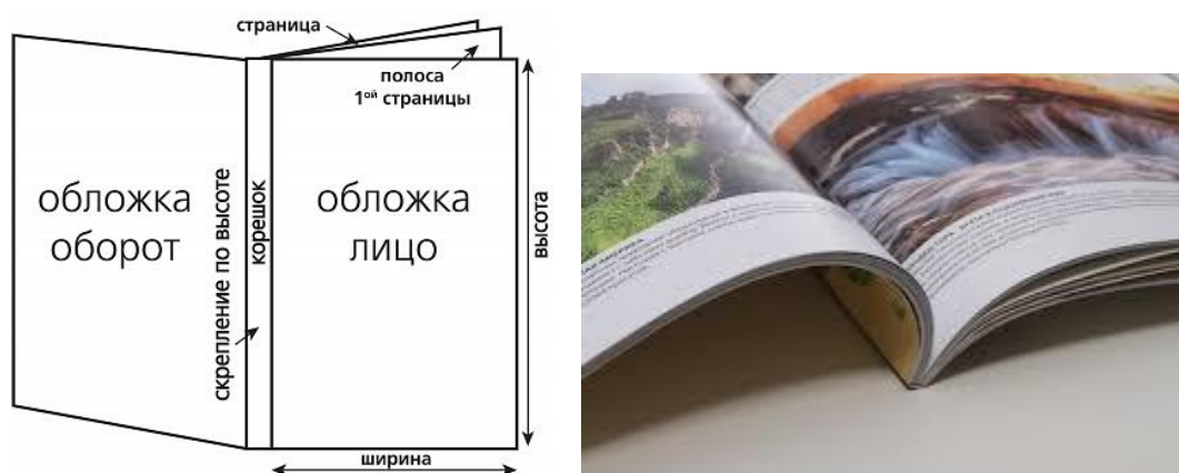
Рис. 8. Конструкция и внешний вид брошюры (журнала), скрепленного в корешке клеевым способом
