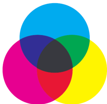
Рис. 29. Субтрактивный синтез цвета с применением трех основных красок: голубой, пурпурной, желтой
