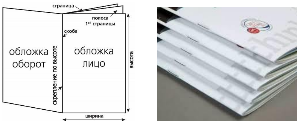
Рис. 7. Конструкция и внешний вид брошюры (журнала), скрепленного двумя скобами
