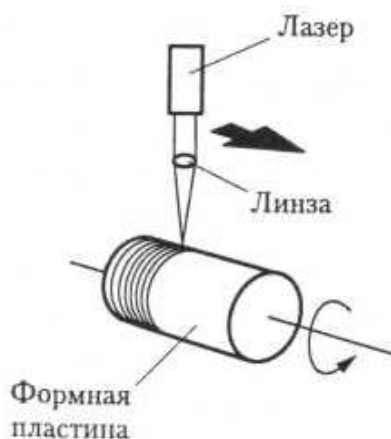
Рис. 39. Схема работы устройства Computer-to-Plate
