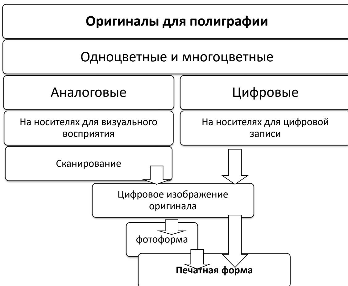
Рис. 17. Технологическая схема допечатной этапа подготовки изображений к печати
