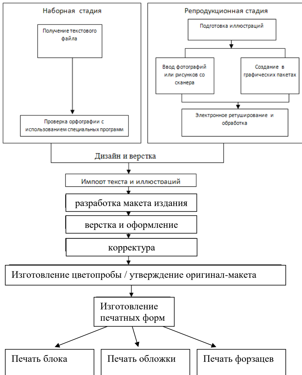
Рис. 13. Пример технологического маршрута допечатного и печатного процессов изготовления книги в мягкой обложке
