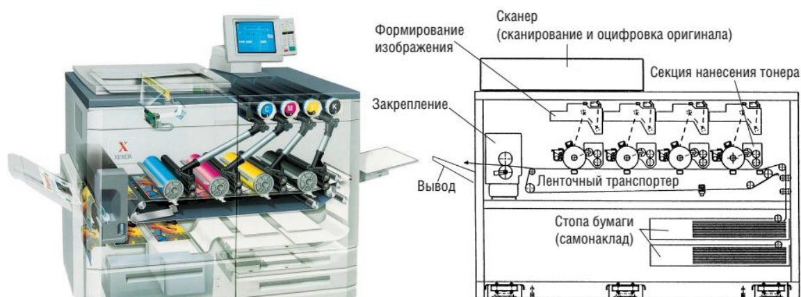
Рис. 52. Бесконтактная печатная система (электрофотография) многокрасочной печати: а – внешний вид секционной электрофотографической системы для много-красочной печати с проводкой листа транспортером для двухсторонней печати; б – схема секционной электрофотографической системы
