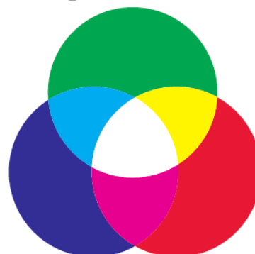
Рис. 30. Аддитивный синтез цвета с применением трех основных излучений: красного, зеленого, синего
