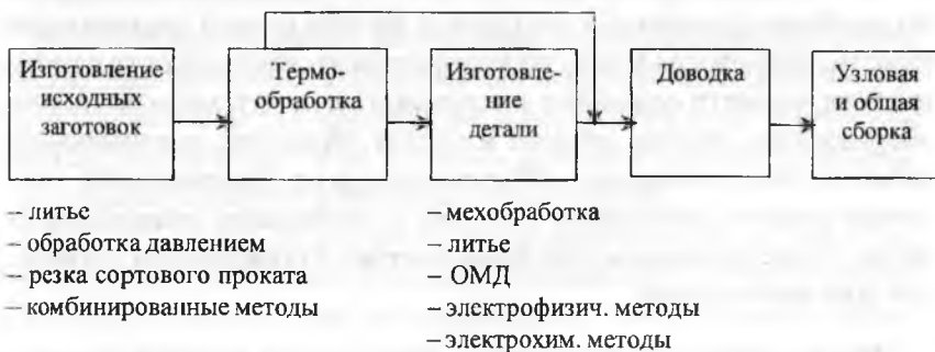
Рис. 1.1. Типовая схема технологического процесса в машиностроении
