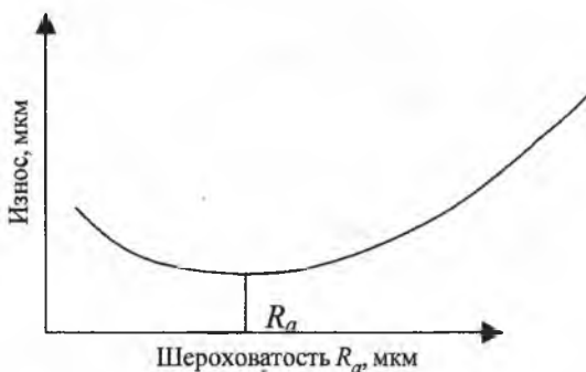
Рис. 4.6. Влияние шероховатости поверхности на износ
