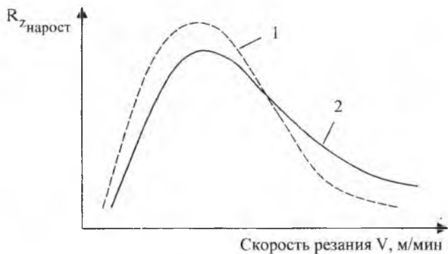
Рис. 4.2. Зависимости величин R_z (кривая 2) и нароста обрабатываемого материала (кривая 1) от скорости резания
