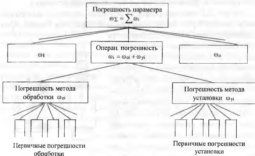
Рис. 2.3. Схема классификации погрешностей
