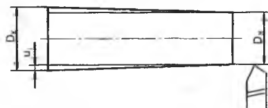
Рис. 2.7. Схема образования погрешности формы в результате размерного износа инструмента
